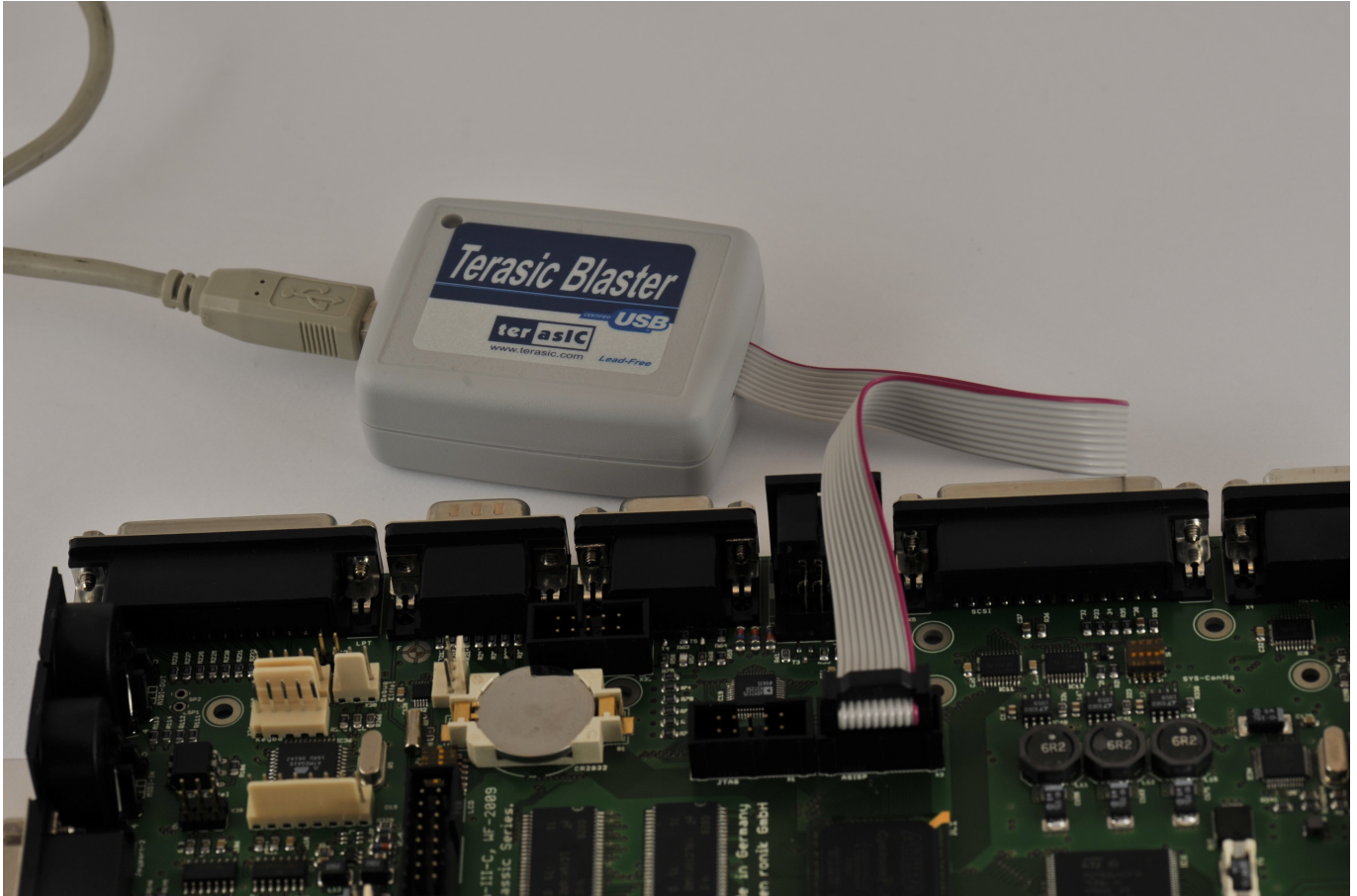
Abbildung 20: Anschluss eines USB Blasters an die Active-Serial Schnittstelle.
